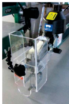
Kuvassa Pegas SCP21C -konelehtisaha. Kuva kouluvarustukseen kuuluvasta sormisuojusta alhaalla vasemmalla.
